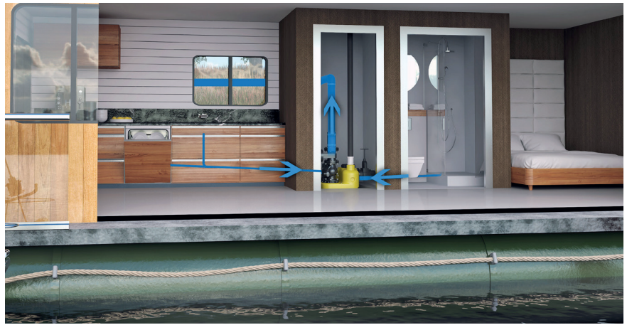
Das Abwasser aus Spüle und Bad läuft in die compli Hebeanlage und wird in eine Leitung oder einen Behälter an Land gepumpt.
