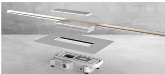
Gewerketrennung mit dem geeigneten Ablaufgehäuse der **Dall-Flex-Familie** vereint. Der Sanitärinstallateur setzt den Korpus des Plancofix auf den Rohfußboden und stellt den Anschluss an die Entwässerungsleitungen her. Der Fliesenleger bindet die werkzeuglos aufklickbare Dichtmanschette vor dem Auftragen der AIV per Clips an das Gehäuse des Plancofix an.
