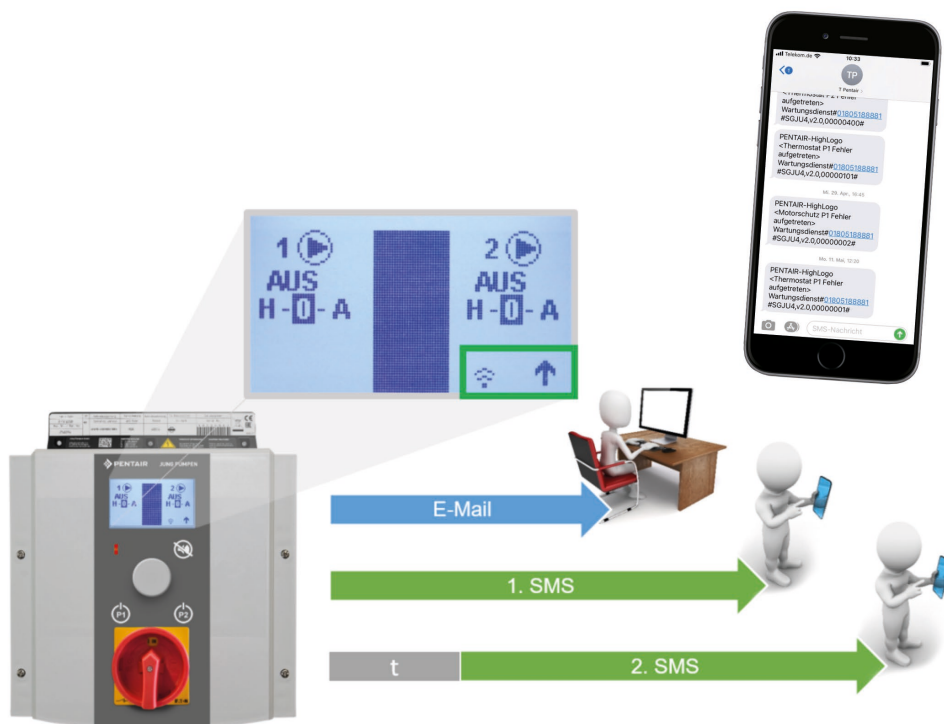
Bild 1: Das neue GSM-Modul ermöglicht im Störfall die Benachrichtigung von bis zu 3 Alarmempfängern per SMS oder E-Mail
